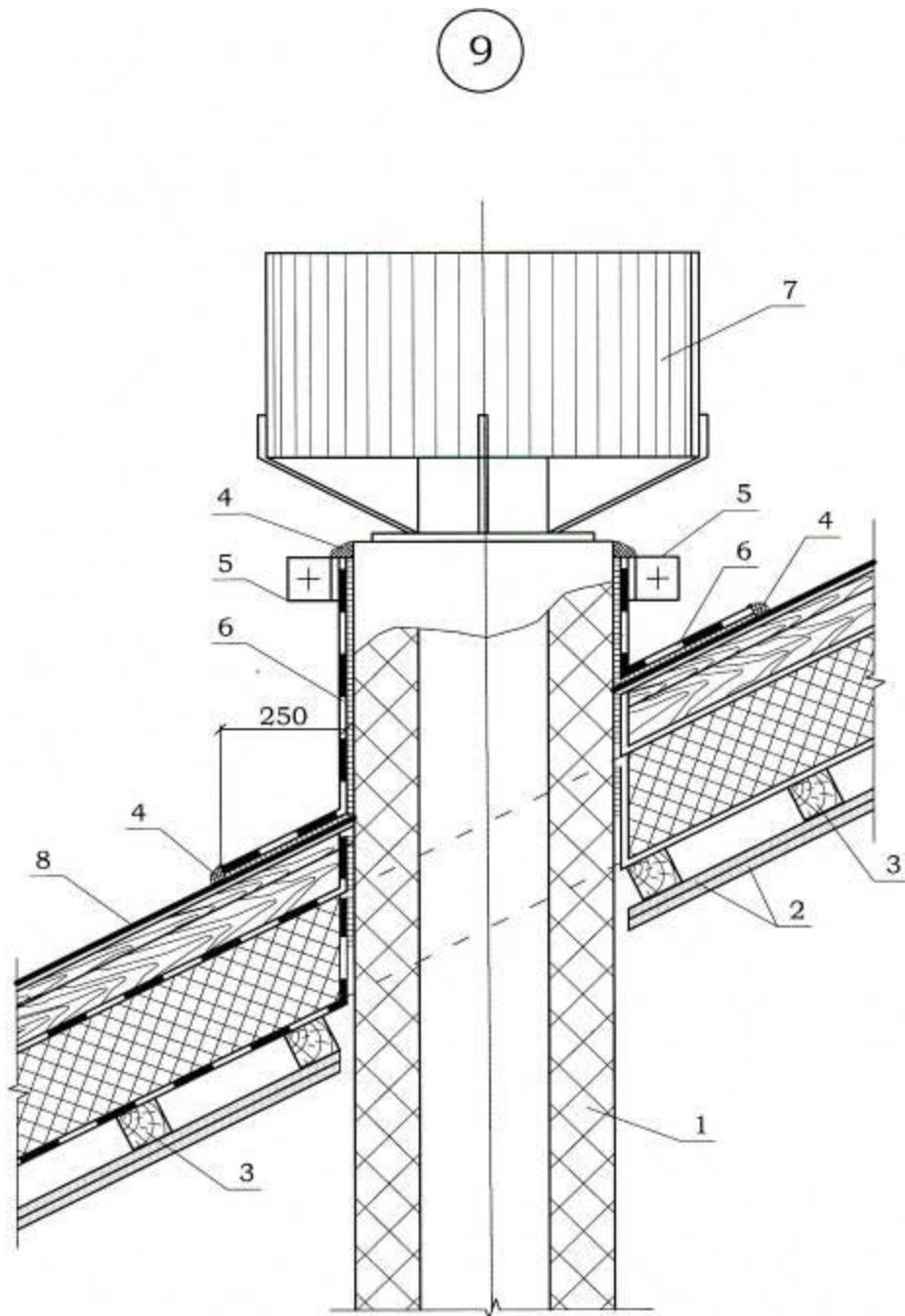
*Узел 9. Примыкание кровли из гибкой черепицы
