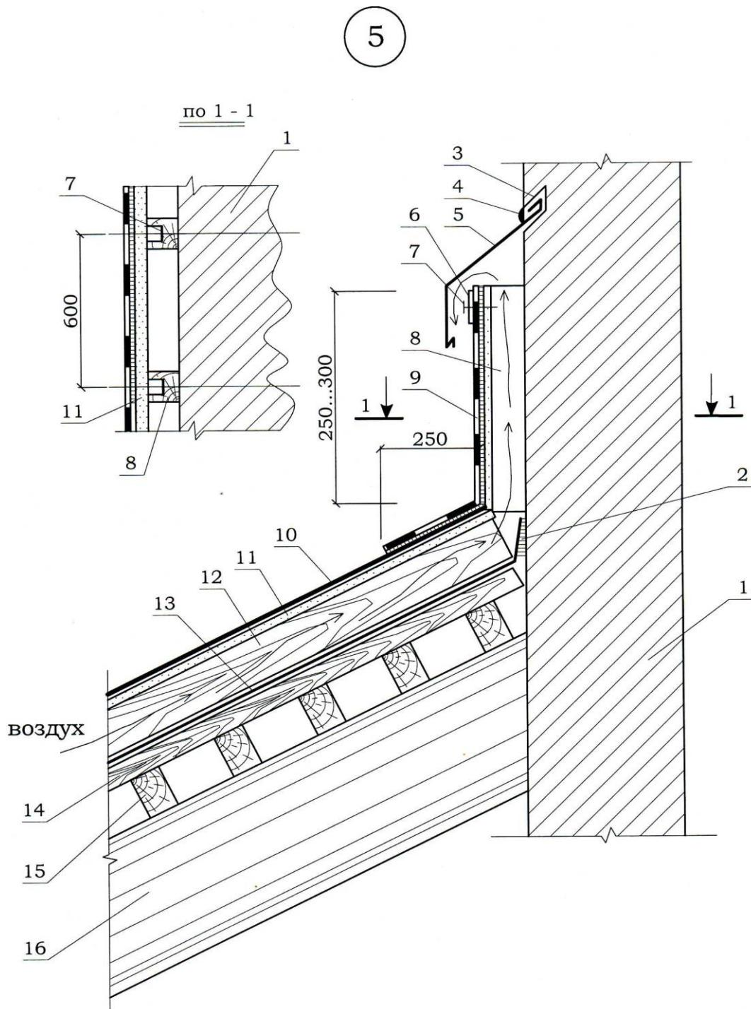
*Узел 5. Примыкание кровли из гибкой черепицы
