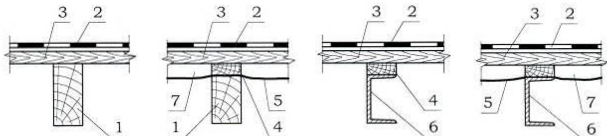
*Рисунок 3.3. Неутеплённые крыши с кровлей из гибкой черепицы*
